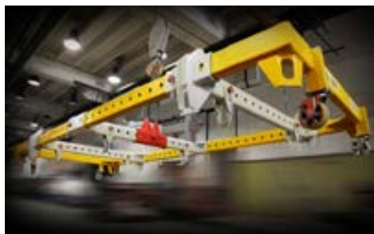
Trawersa z regulowanymi elementami do uniwersalnego zastosowania
