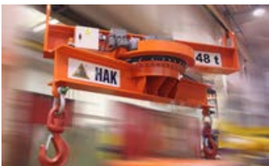
Trawersa obrotowa z napędem elektrycznym
